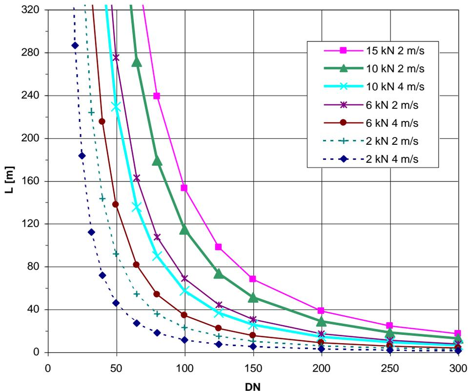
Diagramm 1: maximale Leitungslänge in Abhängigkeit der Strömungsgeschwindigkeit, der Stellkraft des Antriebes und der Nennweite
